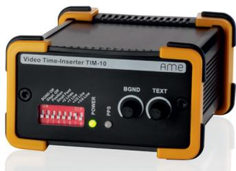
Die Bedienung des Time-Inserters beschränkt sich auf die Konfigurationsschalter und zwei Einstellregler für die Einblendung. Alle Einstellungen können während des laufenden Betriebs verändert werden.
